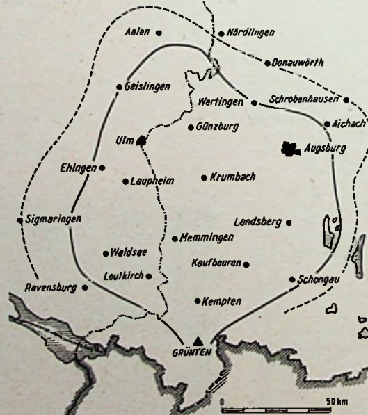
Bild 2. Reichweite des Fernsehsenders Grünten. Die bisher mit dem UKW-Sender gemachten Erfahrungen lassen das durch die ausgezogene Linie begrenzte Versorgungsgebiet erwarten. In der Zone zwischen der ausgezogenen und der gestrichelten Linie kann man vielfach bei höherem Antennenaufwand ebenfalls zufriedenstellenden Empfang erwarten.
