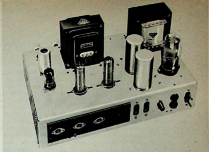
Bild 6. Ansicht des Chassis von der Anschlußseite. Die abgeschirmten Eingangsbuchsen sitzen auf einer gemeinsamen Isolierplatte
