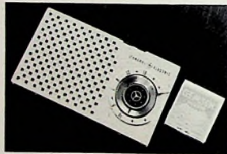
Bild 1. Der Taschenempfänger 676 der General Electric mit fünf Transistoren ( 14 \times 8 \times 4 cm; 450 g)
